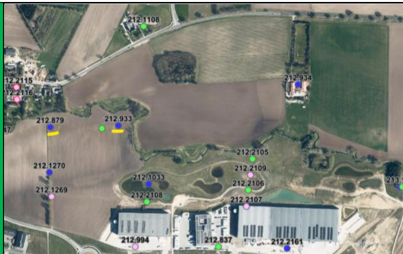
Figur 13 Boring DGU212.933 har i 1994 haft højt indhold af TCE. DGU212.1270 er en afværgerboring.
